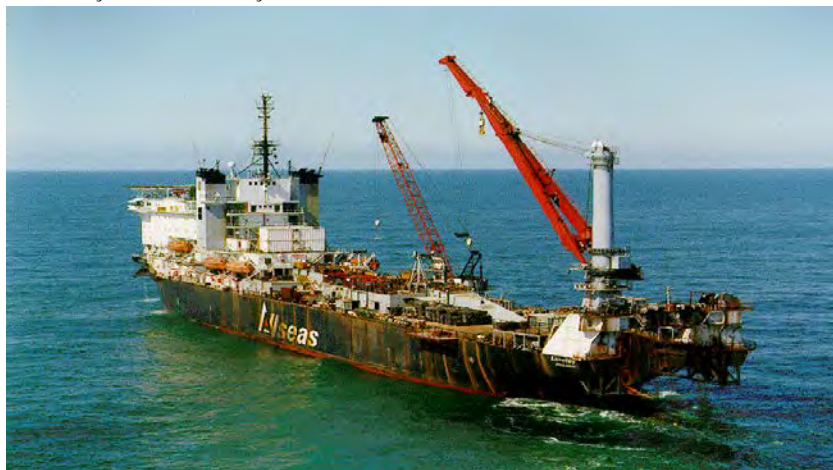
Embarcação de Colocação de Gasodutos em Águas Profundas
