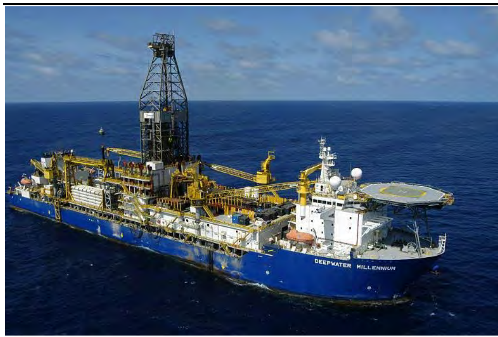
Figura 4.7 Exemplo de uma Embarcação de Perfuração de Posicionamento Dinâmico
