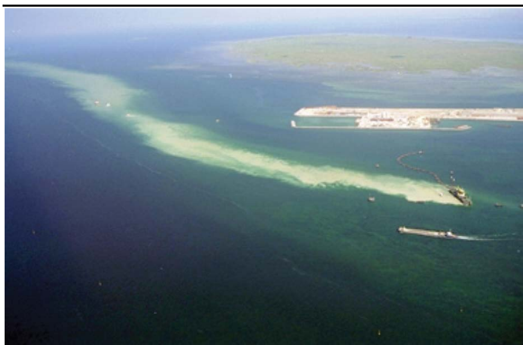
Figura 11.13 Exemplo de uma pluma de turvação gerada por uma draga de sucção e corte a dragar estruturas de corais
