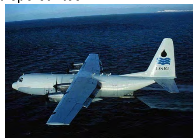
Figura 1-10 Sistema de aplicação por via aérea
